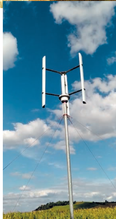
A unidade será utilizada como objeto de pesquisa e validação quanto a geração eólica de pequeno porte em geração distribuída
