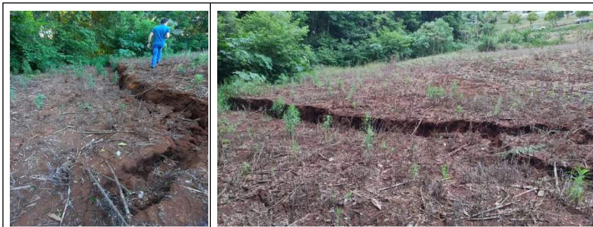
FIGURA 09 – Fotografia mostrando movimentação do solo do lote 07, da quadra 1540, com cicatriz entre o solo que se movimentou e o perfil de solo original.
