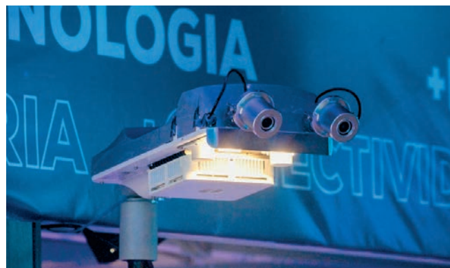
O Conecta 5G consiste em utilizar a iluminação pública ao instalar uma antena em um ponto de iluminação
